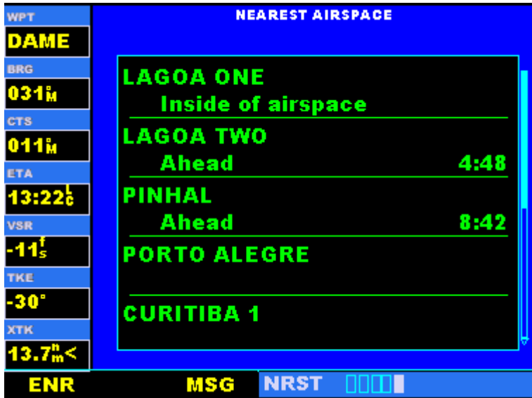
Figura 22: Tela espaços aéreos próximos (Nearest Airspace). Neste exemplo, minha aeronave estava dentro ( Inside ) do espaço aéreo LAGOA ONE , e os espaços aéreos LAGOA TWO e PINHAL estavam à minha frente ( Ahead ), a menos de 10 minutos seu eu mantiver o curso e velocidade actuais. O tempo estimado até cada um dos espaços aéreos também é indicado. Os espaços aéreos PORTO ALEGRE e CURITIBA 1 estão próximos, porém a uma distância maior que 10 milhas. Por isso não é indicada nenhuma mensagem para eles.
