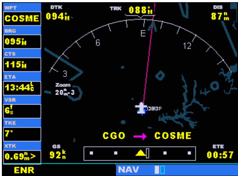
FIGURA 09: Nível de detalhes em -3. Para voltar ao modo normal, aperte CLR novamente.
